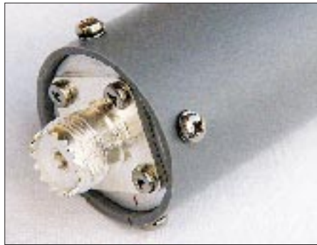
Bild 7: So wird die Leitung mit dem Gehäuse-Plastikrohr verschraubt.
