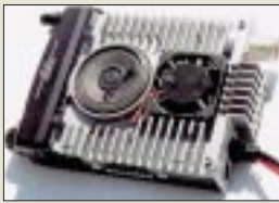
Der FT-90 ist nur 100 x 30 x 138 mm 3 groß und bringt ganze 600 g auf die Waage
