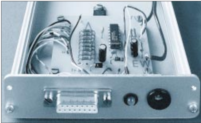
Bild 12: Blick schräg von vorn auf das programmierbare Ladegerät mit dem MAX 713. Links vorn die Sub-D-Buchse für die Programmierung, daneben die Kontroll-LED, rechts die isolierte DC-Buchse. Auf der Platine links sind die acht Widerstände 1 Ω sichtbar. Etwas verdeckt der auf der Unterseite montierte Transistor.
